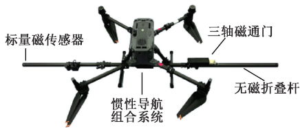
图 8 无人机及携带设备安装位置示意图
