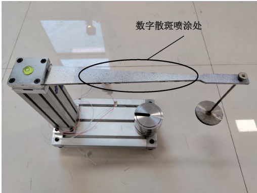
(a) 表面喷涂散斑图案的等强度梁试件
