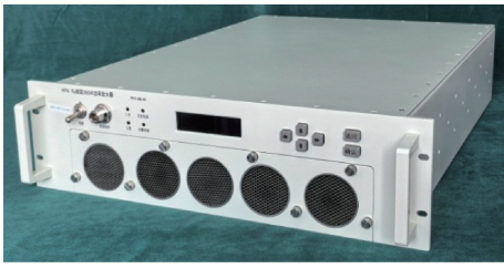
图 12 室内型 Ku 频段 350 W 功率放大器实物照片
