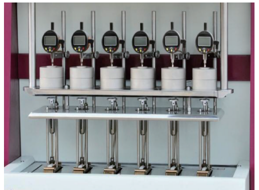
图 3 6 路维卡软化温度测定仪校准装置 Fig. 3 6-channel Vicat softening temperature tester
